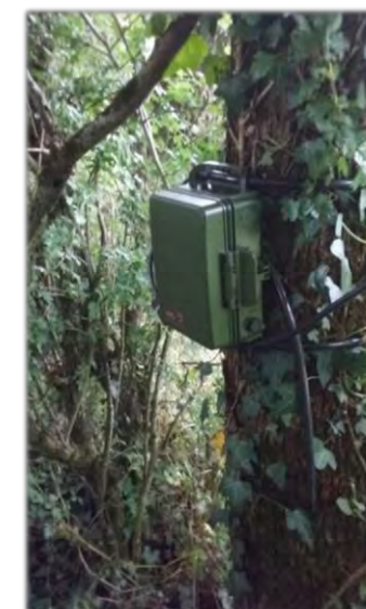
Figure 200 : Installation d'enregistreur continu SM4BAT © NCA Environnement
